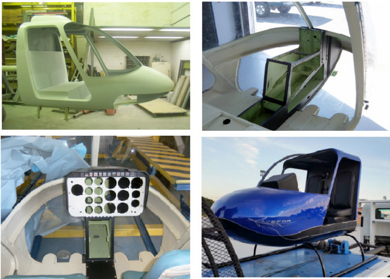
Figura 1. Cabina rediseñada con nuevos materiales. (Fuente propia 2018)
