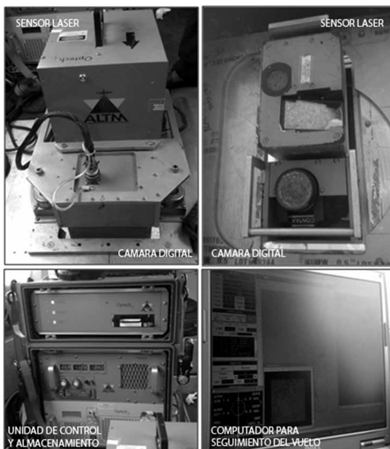
Figura 3. Componentes del sistema LiDAR
