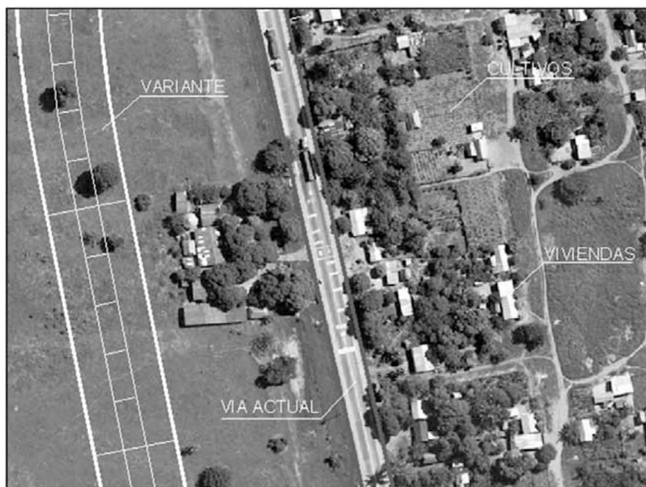
Figura 7. Diseño Geométrico sobre ortofotos. Proyecto Ruta del Sol. Colombia.
