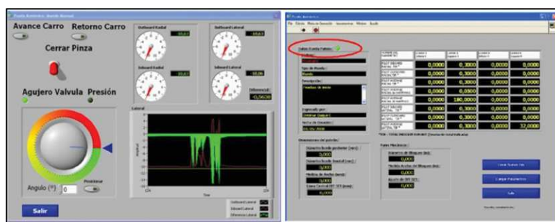
Figura 4. Interfaz en Labview Función Modo Manual (Izquierda) y Modo Automático (Derecha) (Duque, 2008)
